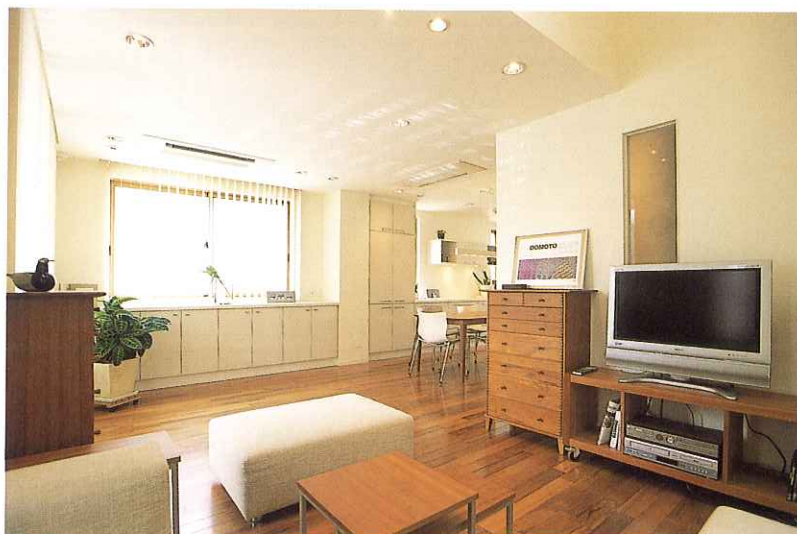
リビングからダイニングを見る。ダイニングをはじめ、家中の窓に木質調の樹脂製ペアガラスサッシを使用し、断熱性を確保している。
